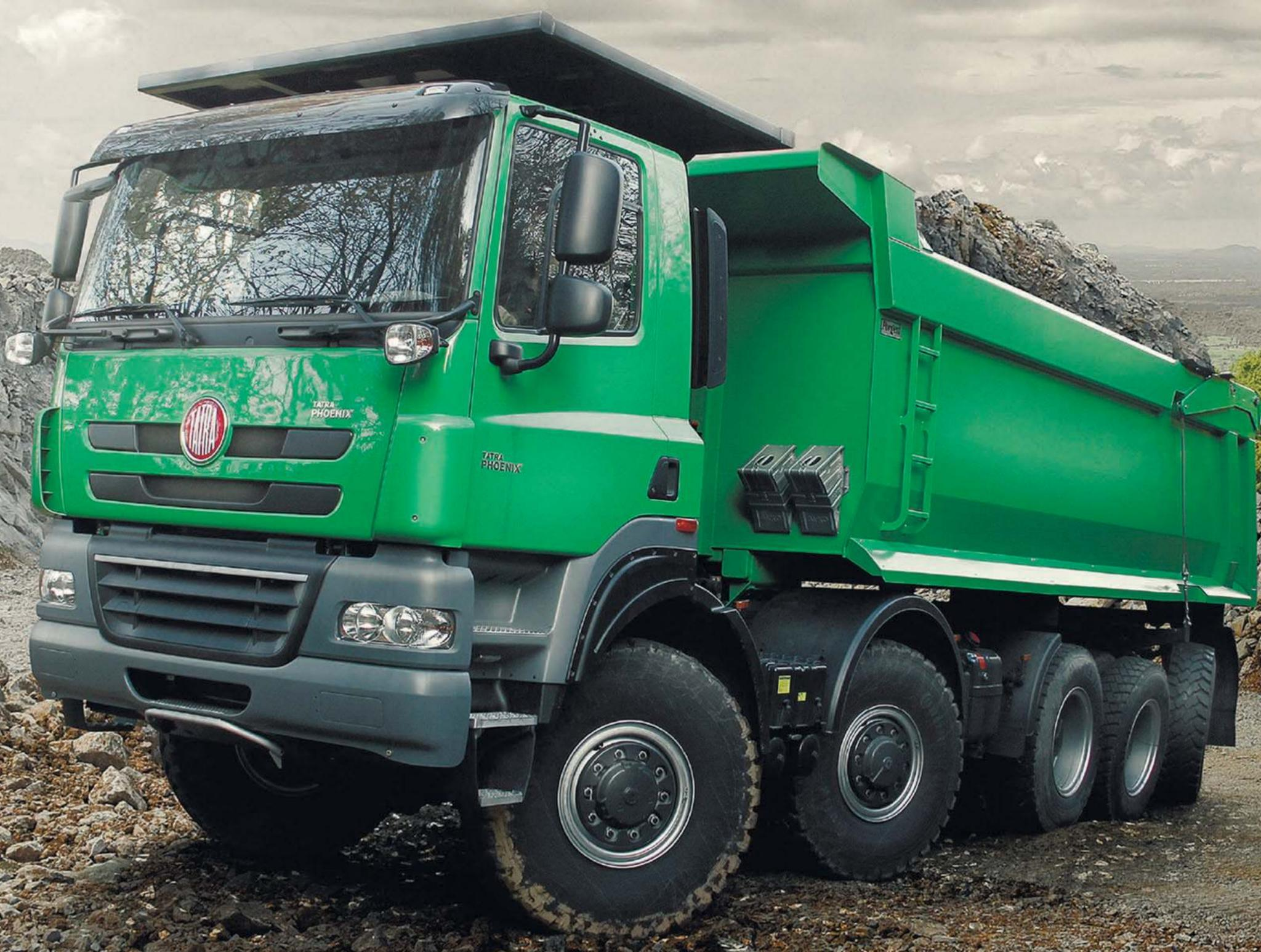
С более чем 120-летним опытом разработок и производства в автомобилестроении, TATRA поставляет надежные и проверенные временем грузовики с выдающейся производительностью, эффективностью, мобильностью и комфортом во время езды, как на дорогах так и по тяжелому бездорожью. Все это благодаря уникальной конструкции шасси TATRA - центрально „хребтовой“ раме, с независимой подвеской и качающимися полуосями, устойчивой к скручиванию и изгибу.
