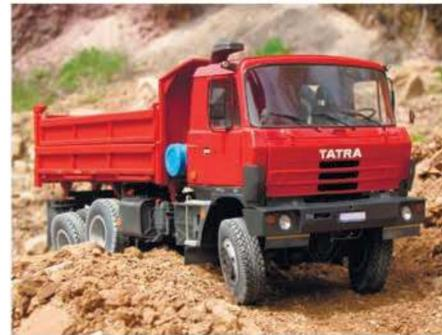
На самосвалах Татра 815 можно перевозить различный груз не только по асфальту но и по тем местам, где дорожное полотно полностью отсутствует. Полноприводная трансмиссия повышает проходимость до уровня вездеходов.
